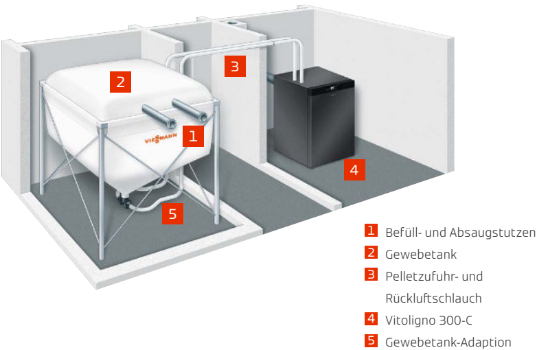
Lagerraum ohne Schrägboden mit Zuführung zum Pelletkessel über Saugsonden
